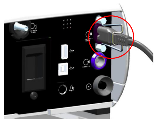
Cable eléctrico con dispositivo antitirón
